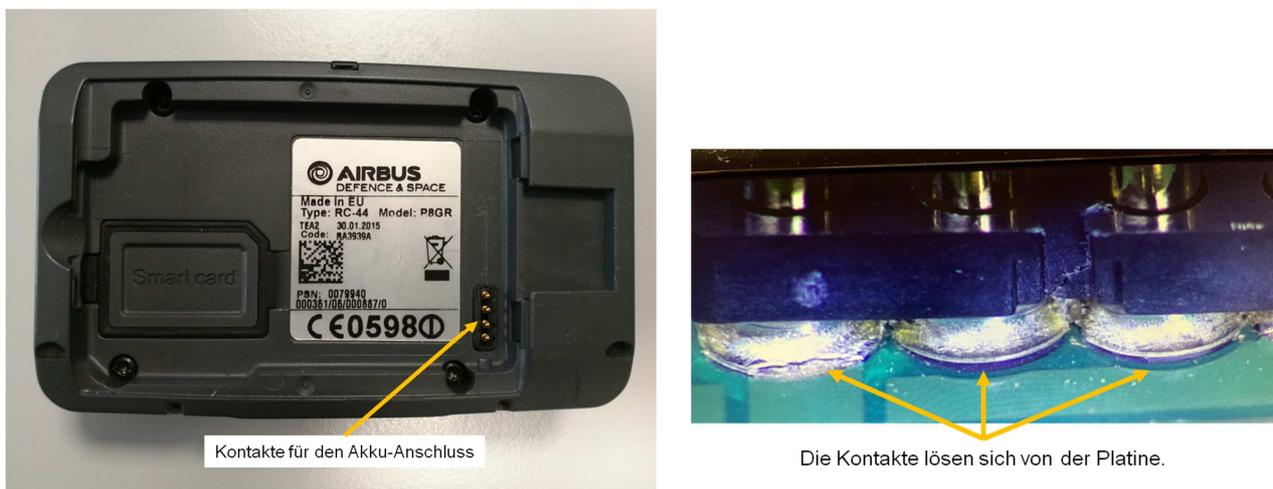
Abb. 1.1: Pager ohne eingelegten Akku / Abriss der Kontakte
