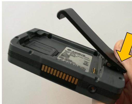
Abb. 2.2: Öffnen des Gürtelclips
