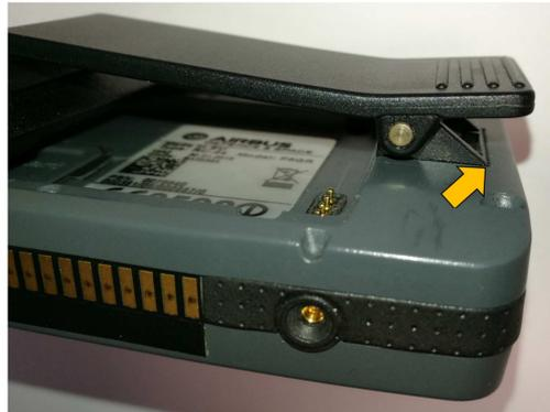
Abb. 2.1: Vollständiges Einschieben des Gürtelclips in die Aussparung
