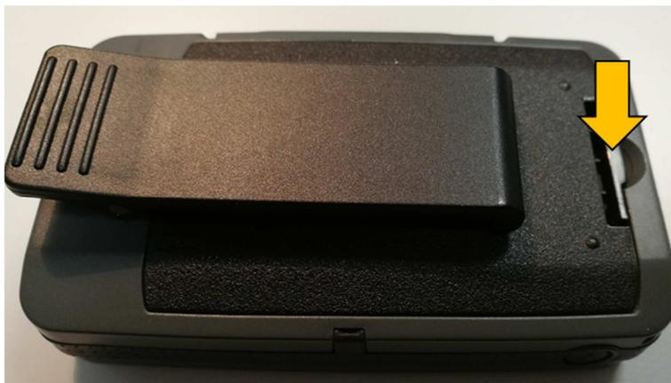
Abb. 2.6: Einrasten des Akkus in seiner Position
