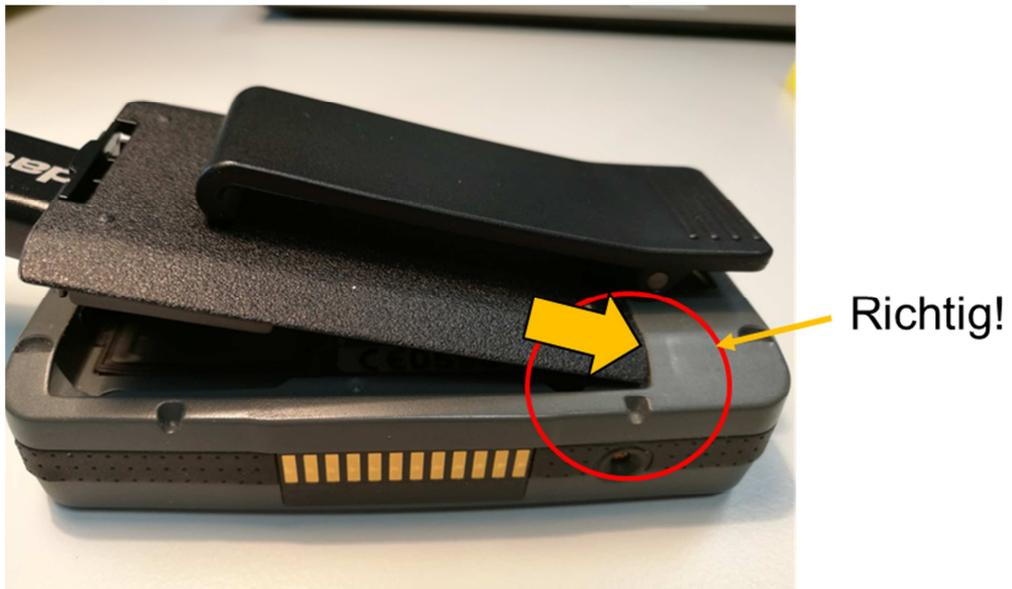
Abb. 2.4: Richtiges Einsetzen der Haltezungen des Akkus in die dafür vorgesehenen Aussparungen des Pager-Gehäuses
