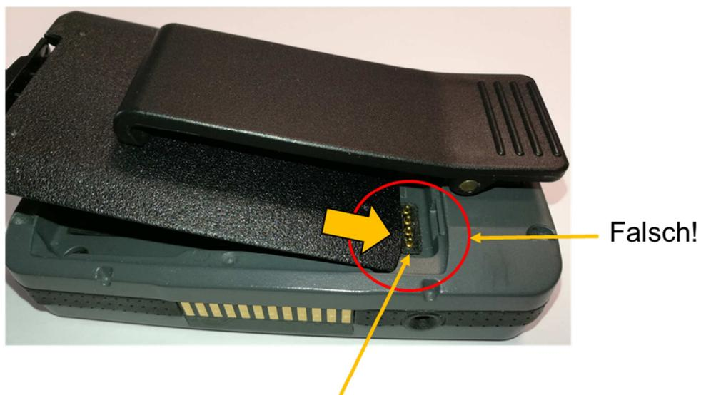
Kontakte lösen sich beim Einschieben des Akkus von der Platine (Abriss der Kontakte).
